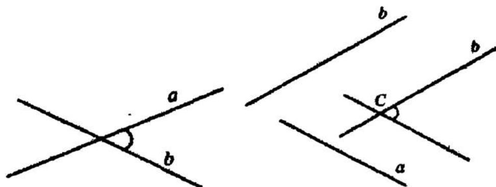
Углом между скрещивающимися прямыми называется угол между пересекающимися прямыми, соответственно параллельными данным.
